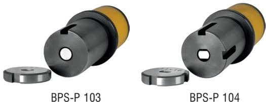
Präzisionsschneide- und Stanzstation für Al-, Cu- und Al-Cu-Stromschienen
