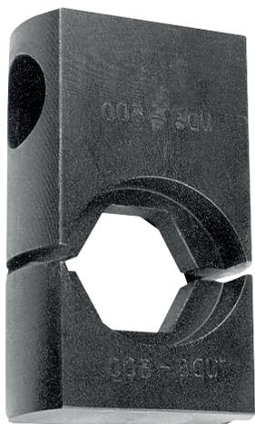
Для трубчатых наконечников и соединителей с внешним диаметром до 52 мм. Поскольку для одного и того же сечения кабеля можно применить наконечники с различной толщиной стенки (нп. выполненные по норме DIN или PN), то матрицы обозначаются дискриминантом, величина которого соответствует внешнему диаметру наконечника в мм.
