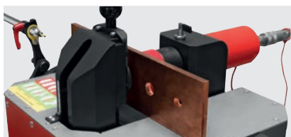
Вырезание отверстий SH 303, SH 304, SH 309.
