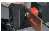
Пробивка отверстий SH 403, SH 404, SH 409
