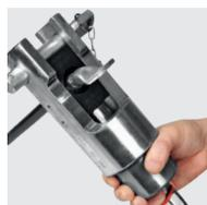
Гидравлическая головка для наконечников и соединителей:
