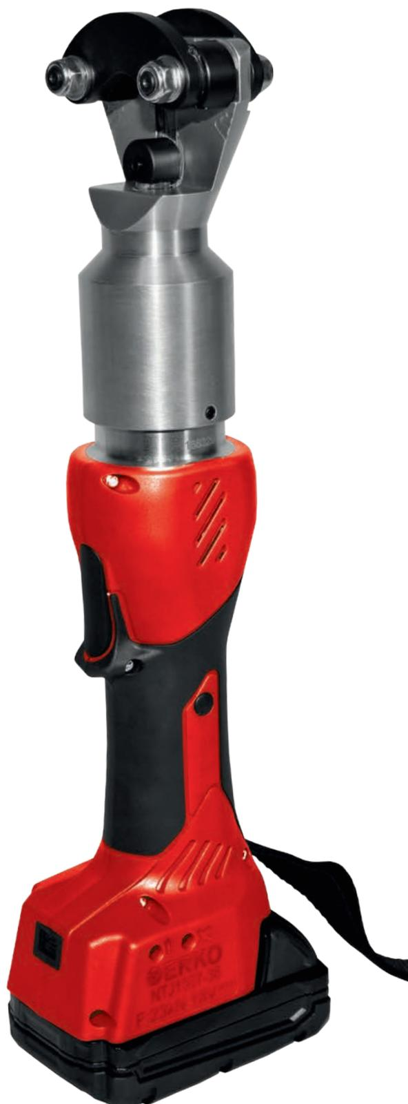
Гибочный аккумуляторный инструмент для поперечной гибки профилированных проводов Al и Cu прямоугольного сечения в размерах:
