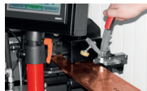
Stromschienenspanner bei Funktion Schneiden.
