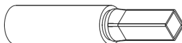
Rys.2. Sposób zaprasowywania a) końcówka rurowa b) złączka rurowa c) końcówka oczkowa d) końcówka tulejkowa.
